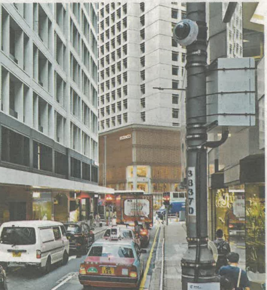
**皇后大道中** 運輸署正與警方合作在中環皇后大道中及觀塘開源道的兩個路段，測試自動交通執法系統，系統包括在燈柱安裝閉路電視攝影機和設備監察交通情況，配合人工智能及自動車牌識別技術，向違泊或違例上落客貨的車輛抄牌。位於中環皇后大道中近雪廠街的系統（圖）昨起開始測試。
